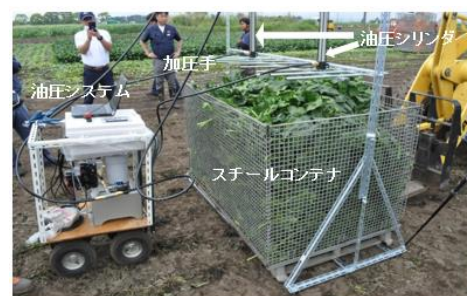
図 2 ホウレン草収穫時における加圧機構
